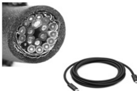
圖四、Thunderbolt 4 傳輸線(外徑 5.24mm)
