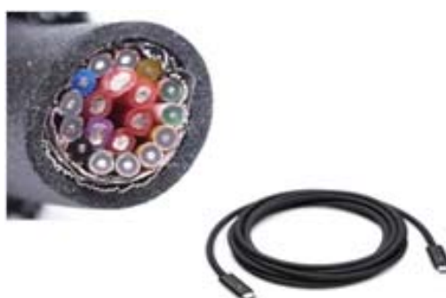
圖四、Thunderbolt 4 傳輸線(外徑 5.24mm)
